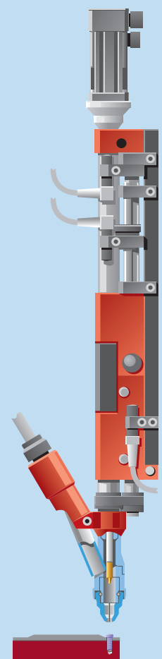
Schraubkopf fährt in die Grundstellung zurück
